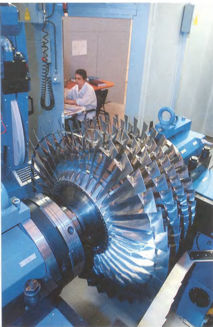
Проверка качества обработки лопаток компрессора
