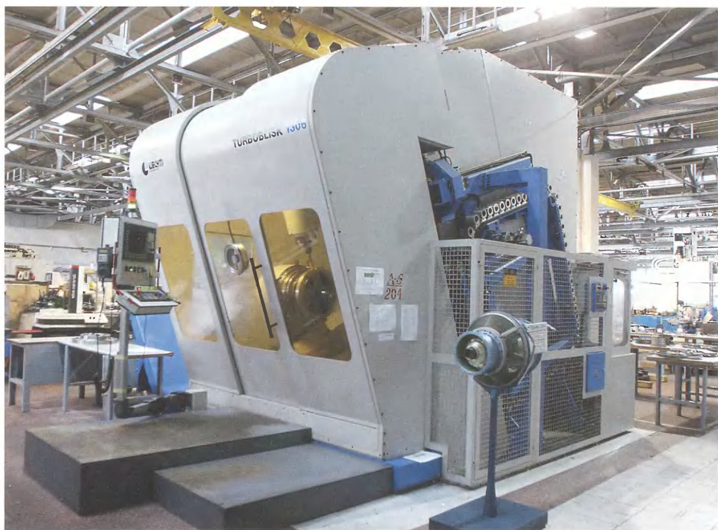
Обработка лопаток турбины ведется на современных станках TURBOBLISK 1306
