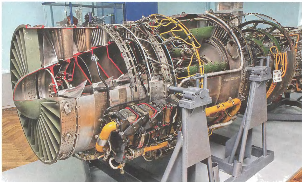
Разрезной макет двигателя P15B-300
