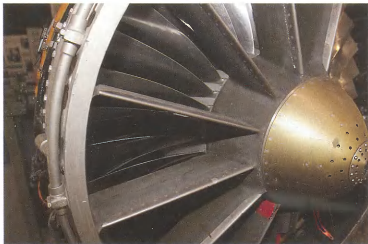
Входной направляющий аппарат и первая ступень компрессора двигателя АЛ-7Ф
