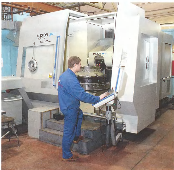
Обработка лопаток турбины ведется на современных станках TURBOBLISK 1306
