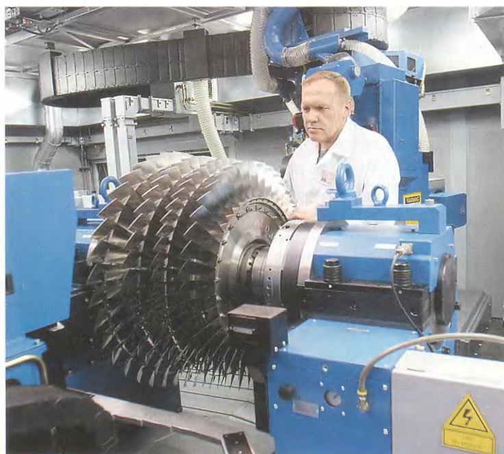
Проверка готовых узлов двигателя на участке контрольных измерений
