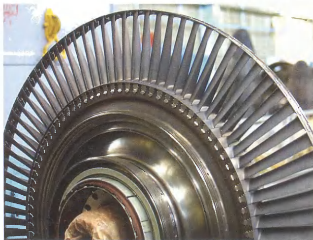
Рабочее колесо турбины низкого давления
