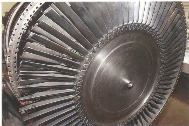
Рабочее колесо одной из ступеней турбины двигателя АЛ-7Ф
